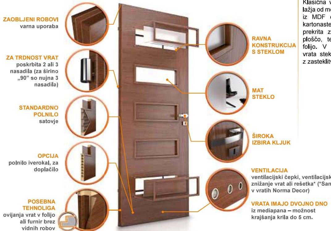
Klasična vrata, ki pa so nekoliko lažja od modularnih, so sestavljena iz MDF okvirja s polnilom iz kartonastega satovja ali iverokala, prekrita z 3 mm debelo HDF ploščo, ter ovita v dekorativno folijo. V kolikor imajo klasična vrata steklo je le-to zastekljeno z zasteklitvenimi letvicami.
