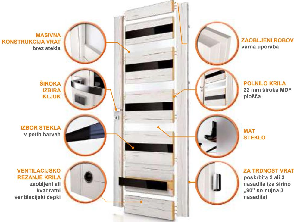
Modularna vrata so sestavljena z dveh vertikalnih in dveh horizontalnih elementov. Polnilo modularnih vrat so MDF paneli različnih debelin ali steklo debeline 4 mm. Za vsak model pa lahko izberete različne dekorativne folije. Steklo ali MDF polnilo v teh vratih ni pritrjeno z letvicami, temveč skupaj z ostalimi konstrukcijskimi elementi vratnega krila, kar še poveča kakovost in stabilnost vrat.
